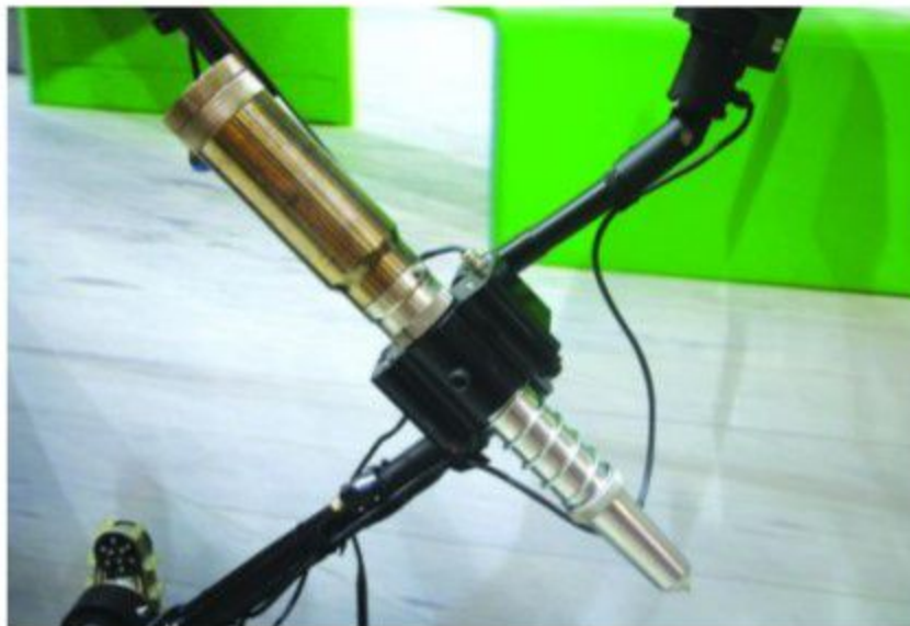
Wyrzutnik wyróżnia 40-mm gwintowana lufa, regulator objętości gazu w kompensatorze oraz zielone wskaźniki laserowe / Zdjęcia: Michał Jaroński
