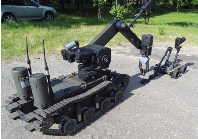
Wykręcanie zapalnika granatu przy pomocy małego PIAP SCOUT oraz dużego robota EXPERT
