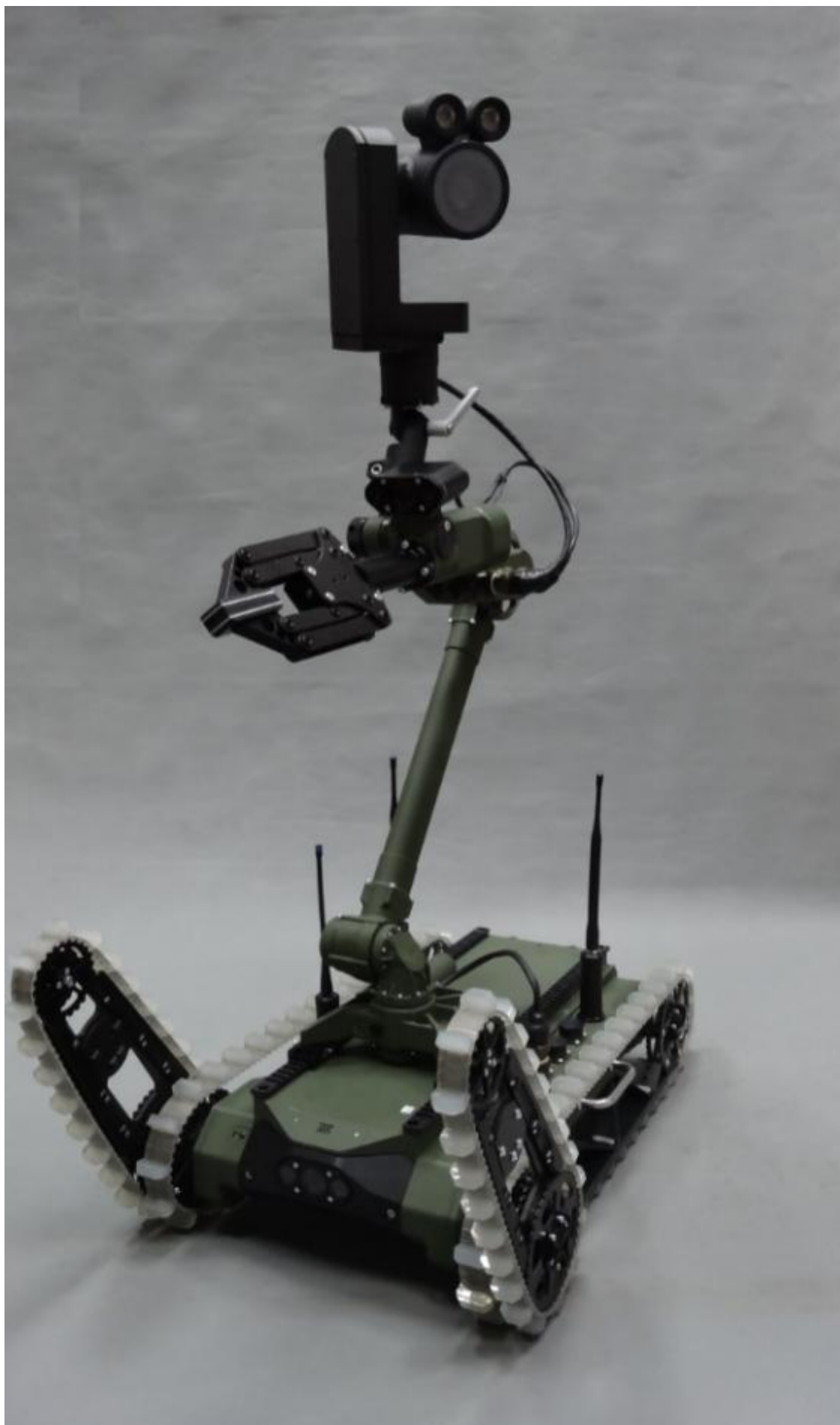
Odchudzony PIAP GRYF może podejmować ładunki o masie do 10 kg /Zdjęcia: PIAP
