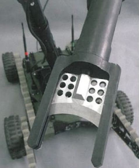
KOŃCÓWKA DO PRZECINANIA Z PROWADZENIEM O SZEROKOŚCI 50 MM.
