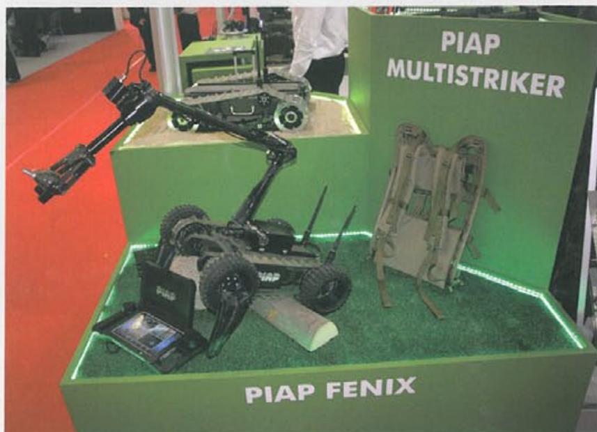
PIAP Fenix w pełnej konfiguracji; robot wraz z chwytakiem roboczym, panel sterowania oraz nosilka umożliwiające wygodny transport zestawu pojedynczemu żołnierzowi
