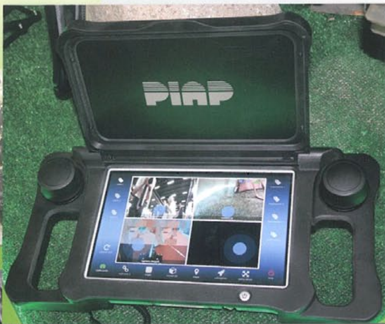
Konsola operatora, o masie 3 kg, ma wymiary 420x200x60 mm. Pozwala na sterowanie robotem za pomocą joysticka lub gamepadu
