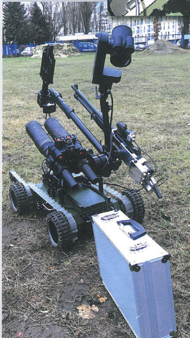
Gryf dla sił zbrojnych Republiki Korei ma podwójny uchwyt wyrzutnika pirotechnicznego, który umożliwia oddanie dwóch strzałów bez konieczności powrotu robota do operatora celem przeładowania
