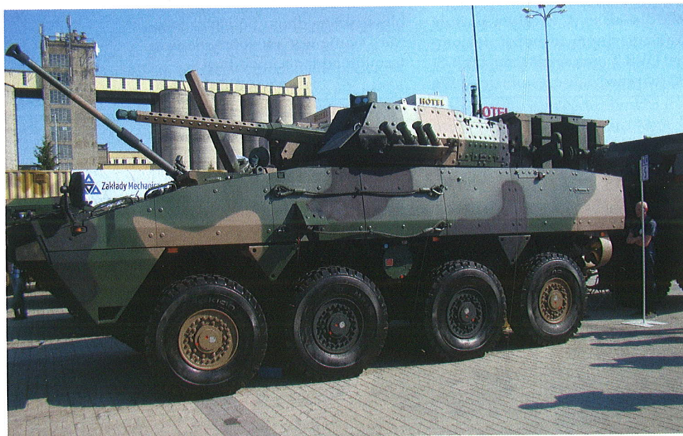
KTO Rosomak ze zdalnie sterowanym systemem wieżowym z wyrzutnią PPK Spike
