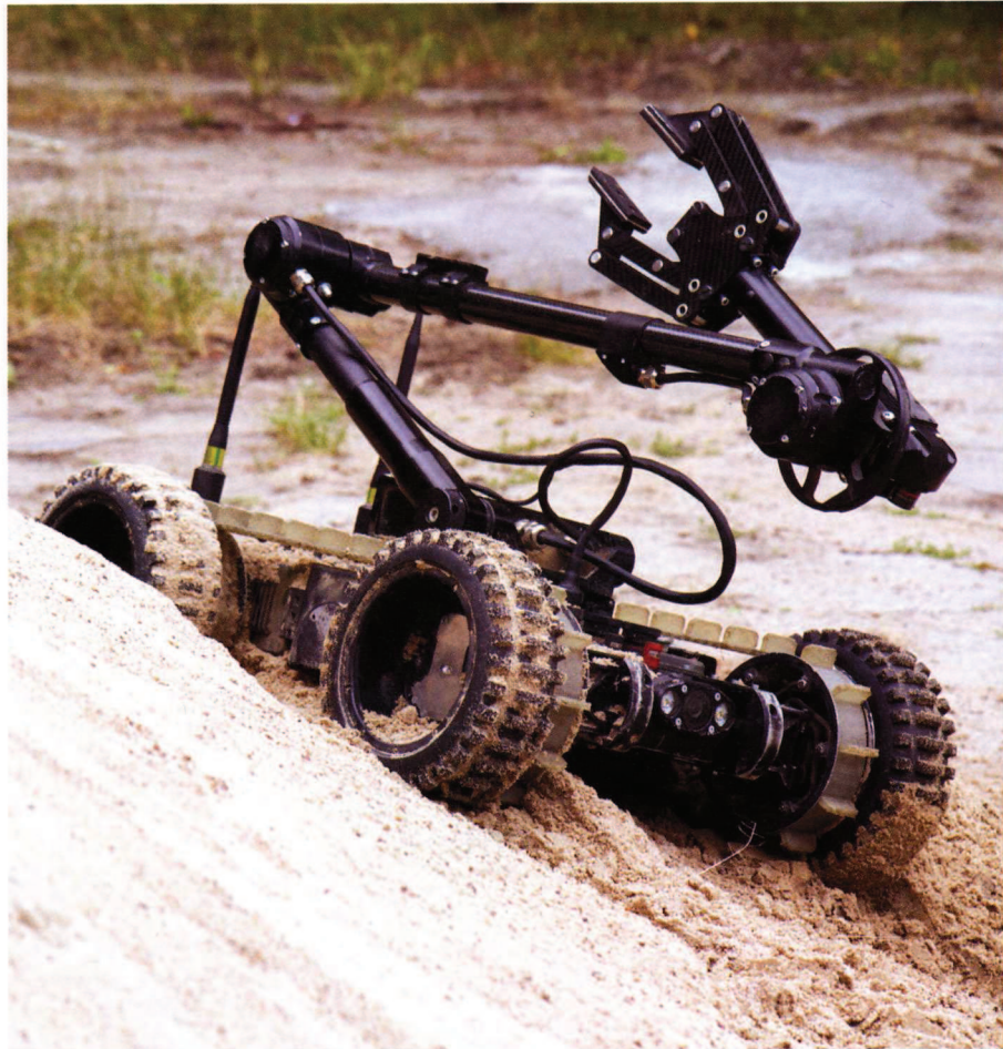
Lekki robot rozpoznawczy Fenix. Urządzenie zostało zaprojektowane na potrzeby formacji rozpoznawczych wojsk lądowych. Dla jednostek inżynieryjnych zostanie nieznacznie zmodyfikowane Zdjęcie: PIAP
