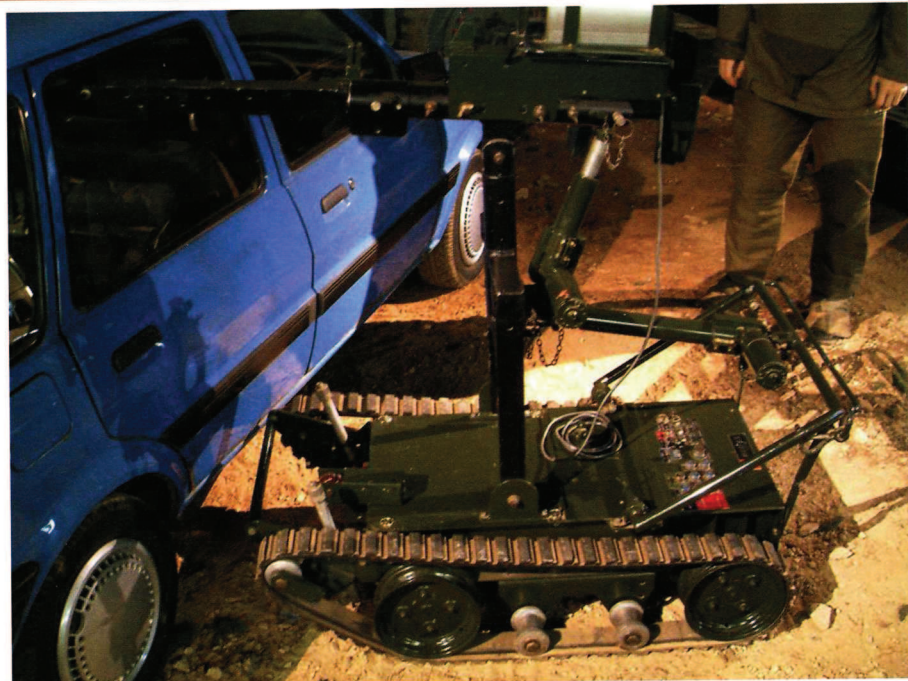
Brytyjski Weelbarrow, pierwowzór wszystkich robotów inspekcyjnych i rozpoznawczych. Wyzначył standard konstrukcyjny i podstawowe zasady wykorzystywania / Zdjęcie: Mark Murphy
