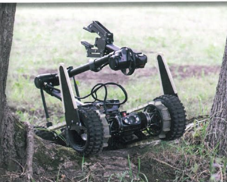
▲ W kadłubie Fenixa osadzony jest układ jezdny – w przypadku najmłodszego dziecka PIAP-u jest to układ kołowo-gąsienicowy z dodatkowymi stabilizatorami przednimi.
