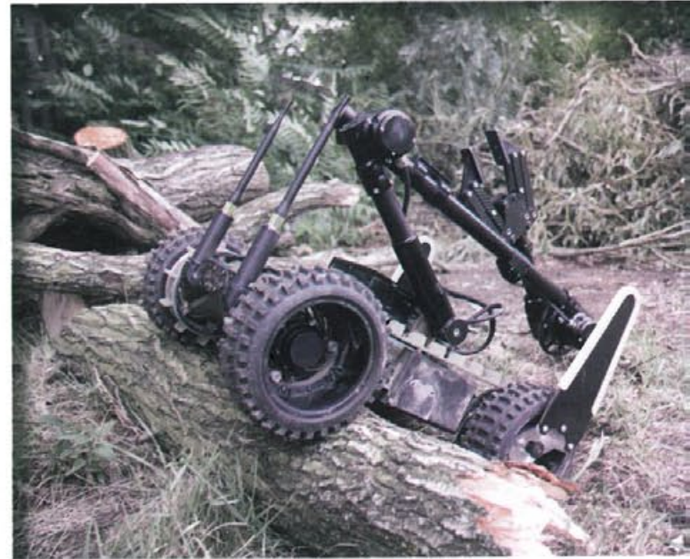
▲ W kadłubie Fenixa osadzony jest układ jezdny – w przypadku najmłodszego dziecka PIAP-u jest to układ kołowo-gąsienicowy z dodatkowymi stabilizatorami przednimi.
